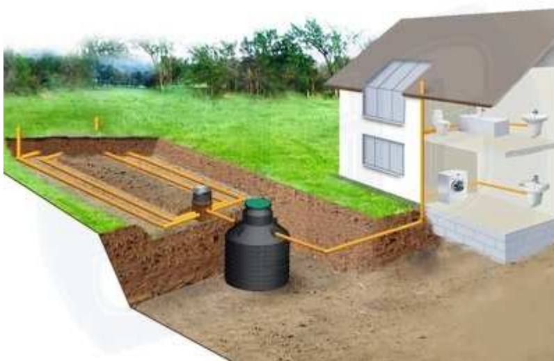
RYСУNEK 16. PRZYKŁAD ZESTAWU: OSADNIK GNILNY + DRENAŻ ROZSĄCZAJĄCY.
