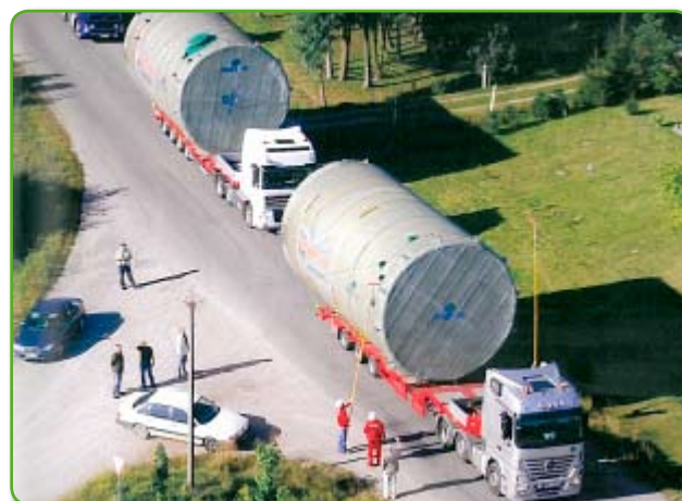
ZBIORNIKI Z LAMINATU POLIESTROWO-SZKLANEGO (GRP) DO 200 m 3 WYKONYWANE NAJNOWOCZĘSZĄ TECHNOLOGIĄ NAWIJANIA KRZYŻOWEGO
